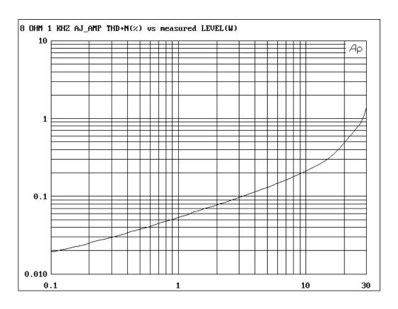
**DISTORTION VS POWER @ 1KHZ**
